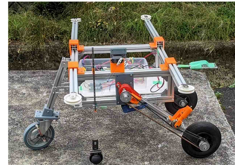
水路壁面の撮影を行うロボット
