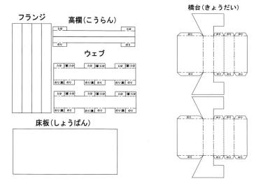
上の図は、住民の方々のために行うインフラの勉強会で、 参加者と一緒に作る橋梁模型の展開図である。株式会社IHI の「ペーパークラフト(桁橋)」を参考にして作製した。
